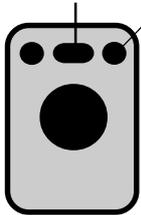
Un Trackball ou une souris compatible Atari rend le contrôle de mouvement très confortable. Dans les modes d'utilisation standards, mode poursuite non actif (voir chapitre 3.3.3), la souris contrôle toujours les scans sélectionnés, simultanément. Contrairement au contrôle par les roues codeuses, la souris (ou le trackball) fonctionne, même quand la fonction Pan/Tilt n'est pas activée dans le mode Accès direct.
