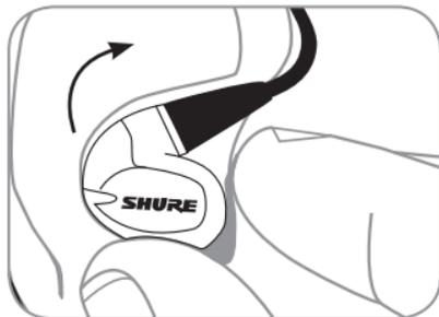
Afferrate il corpo dell'auricolare e ruotatelo delicatamente per rimuoverlo.
