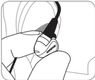
Inserite gli auricolari in modo da creare una tenuta acustica. Il posizionamento dell'auricolare può influire in modo significativo sulla qualità del suono.
