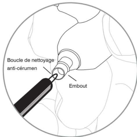
**Attention :** Lors du nettoyage, ne pas faire entrer de force quelque objet que ce soit dans l'embout d'écouteur ! Cela endommagerait le filtre acoustique de l'écouteur.
