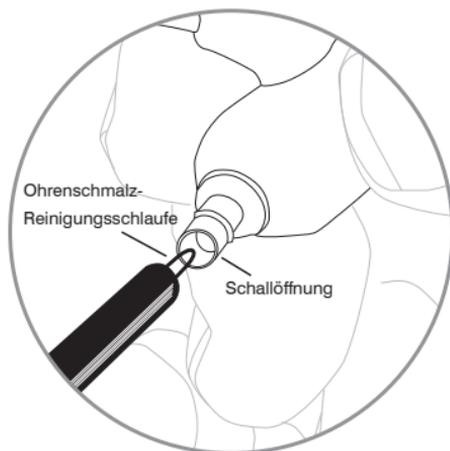
Vorsicht: Beim Reinigen nichts mit Gewalt durch die Ohrhörer-Schallöffnung drücken! Sonst würde dadurch der Tonfilter des Ohrhörers beschädigt.
