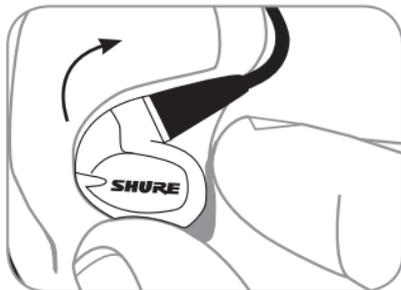
Das Gehäuse des Ohrhörers ergreifen und zum Entfernen behutsam drehen.
