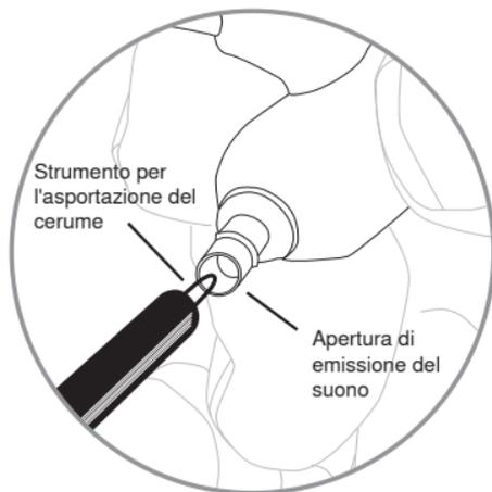
**Attenzione:** Durante le operazioni di pulizia, non forzate alcun oggetto attraverso l'ugello dell'auricolare per evitare di danneggiare il filtro audio dell'auricolare stesso.
