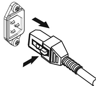
La série K est alimentée par une alimentation universelle. Cette alimentation est capable de faire fonctionner le système à des tensions d'entrée (~) de 100 à 240 V~ à 50 – 60 Hz.
