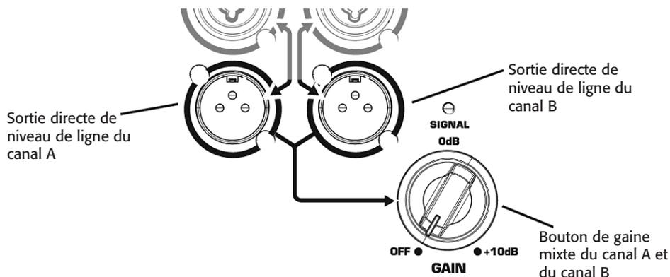
Les canaux A et B ont des sorties directes discrètes sur les connecteurs XLR femelles. Le signal sur cette sortie est équivalent précisément au signal issu de l'entrée correspondante. Le niveau du signal de sortie n'est pas affecté par le réglage du bouton de gain du caisson d'extrêmes graves.
