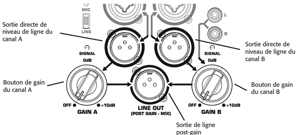
Les canaux A et B ont des sorties directes discrètes sur les connecteurs XLR femelles. Le signal sur cette sortie est équivalent précisément au signal issu de l'entrée correspondante. Le niveau du signal de sortie n'est pas affecté par le réglage de gain correspondant à ce canal. Par ailleurs, le signal délivré aux prises RCA (phono) n'est pas présent sur la sortie de niveau de ligne directe du canal B.
