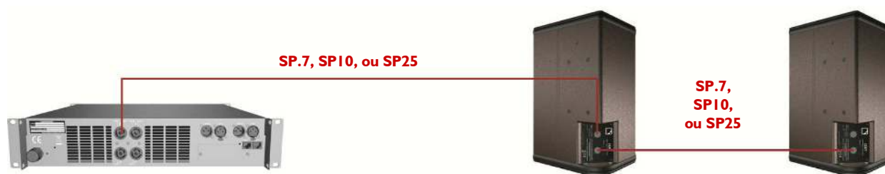
Figure 5 : Connexion de deux enceintes I2XT ACTIVES en parallèle au canal 1 d'un contrôleur LA4 / LA4X
