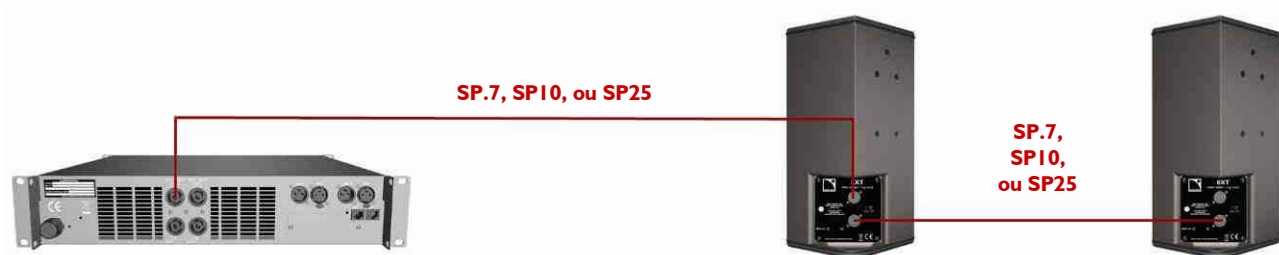
Figure 4 : Raccordement de deux 8XT en parallèle sur le canal I du LA4 / LA4X
