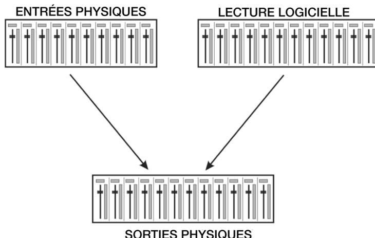
TotalMix peut être utilisé comme dans l'illustration ci-dessus (options de visualisation **2 Rows** ou "2 rangées"). Les canaux d'entrée doivent être placés au-dessus du canal de sortie correspondant. Toutefois, le réglage par défaut est un alignement vertical en 3 rangées comme celui d'une console de mixage Inline, afin que la rangée de *lecture logicielle* corresponde au retour magnétophone (*Tape Return*) d'une véritable table de mixage.
