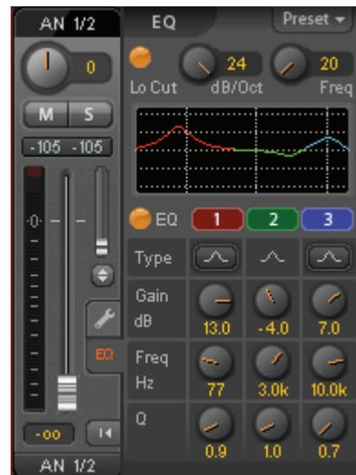
La représentation graphique des fréquences donne une vue précise des résultats du filtre. Le chevauchement des filtres les fait s'influencer entre eux. Cela peut servir à obtenir plus de 20 dB d'amplitude ou à optimiser des réponses en fréquence délicates.
