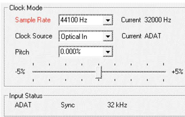
Si la fréquence d'échantillonnage en entrée est différente, alors il n'y aura pas d'indication Sync.
