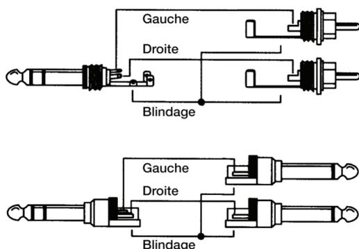
La sortie analogique 3/4 est accessible via une prise jack 6,35 mm 3 points (TRS) stéréo. Cela permet la connexion directe d'un casque. Au cas où la sortie devrait fonctionner comme sortie ligne, un adaptateur jack 3 points/cinch (RCA) ou jack 3 points/jack 2 points est nécessaire.
