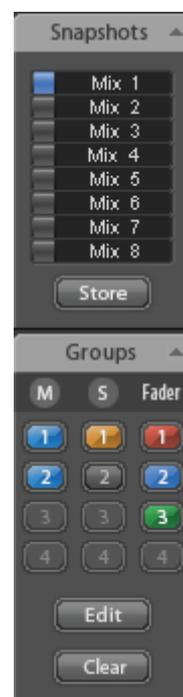
TotalMix utilise des signaux clignotants pour vous guider dans la configuration du groupe. Après un clic sur Edit et un clic sur l'emplacement de stockage désiré, toutes les fonctions désirées pour ce groupe ont été activées ou sélectionnées. Il est mis fin au processus de stockage par un autre clic sur Edit.
