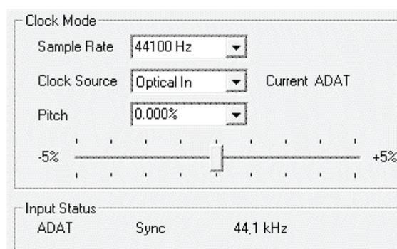
Par conséquent, configurer le logiciel pour un enregistrement numérique est un jeu d'enfant. Après connexion, la Babyface affiche la fréquence d'échantillonnage actuelle et la fréquence d'échantillonnage externe. Ce paramètre peut alors être changé dans le dialogue d'attributs audio (ou réglage similaire) de l'application.
