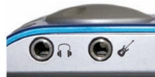
Les sorties analogiques **Phones** (canaux 3/4) sont disponibles par le câble épanoui et sur le côté droit de l'unité. Les connecteurs ne sont pas séparés électriquement. Quand vous branchez deux casques, le volume peut être réduit. Le signal de sortie asymétrique à basse impédance est – en termes de qualité – identique à ceux des sorties ligne, mais limité à +7 dBu.
