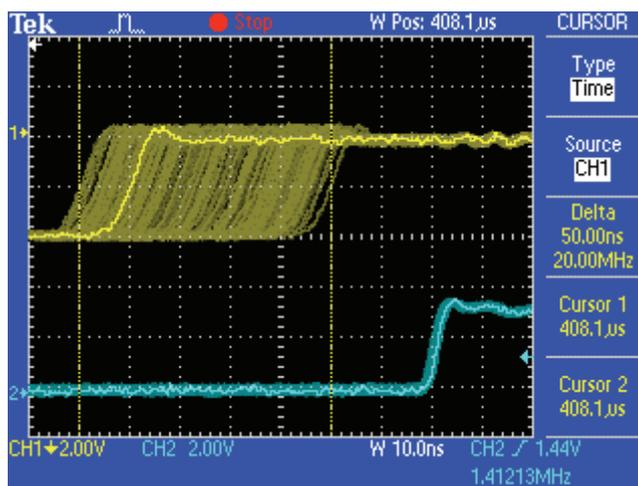
La capture d'écran montre un signal SPDIF avec une gigue extrême d'environ 50 ns (ligne du haut, jaune). Grâce à la SteadyClock, ce signal se transforme en une horloge avec moins de 2 ns de gigue (ligne du bas, bleue). Le signal traité par la SteadyClock n'est bien sûr pas utilisé uniquement en interne, mais sert également à synchroniser la sortie numérique. Par conséquent, le signal rafraîchi et débarrassé de sa gigue peut être utilisé comme horloge de référence sans hésitation.
