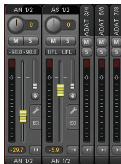
Le symbole flèche du bas réduit la largeur du canal à celle des indicateurs de niveau. Un autre clic lui fait reprendre sa taille. Un clic de souris avec la touche Ctrl enfoncée agrandit et réduit d'un coup tous les canaux situés sur la droite.
