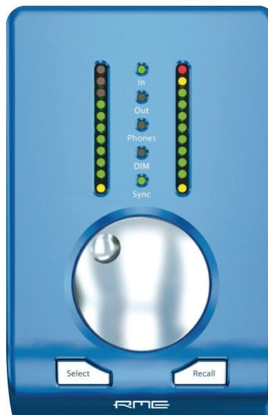
La touche **Recall** sert à mémoriser et rappeler un volume d'écoute spécifique pour la sortie générale Main Out (par défaut : Analog 1/2) définie dans TotalMix FX. Maintenir la molette pressée durant 2 secondes mémorise le réglage actuel. Si le volume (niveau de sortie) a été changé, une pression rapide sur la touche Recall restaurera la valeur antérieure.
