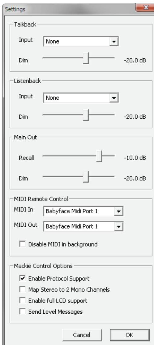
Note : quand MIDI OUT est réglé sur NONE (aucune sortie MIDI), alors TotalMix FX peut toujours être contrôlé par commande MIDI Mackie Control mais le bloc de 8 canaux n'est pas marqué comme destination de commande à distance.
